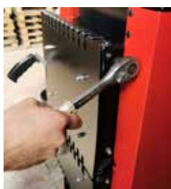
Regulacja drzwiczek (poluzować śruby, ustawić drzwi, dokręcić śruby)
