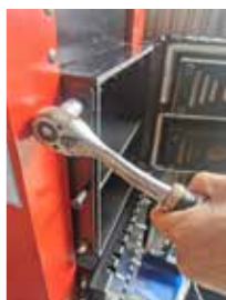
Regulacja rygla zamka (poluzować, ustawić, dokręcić)
